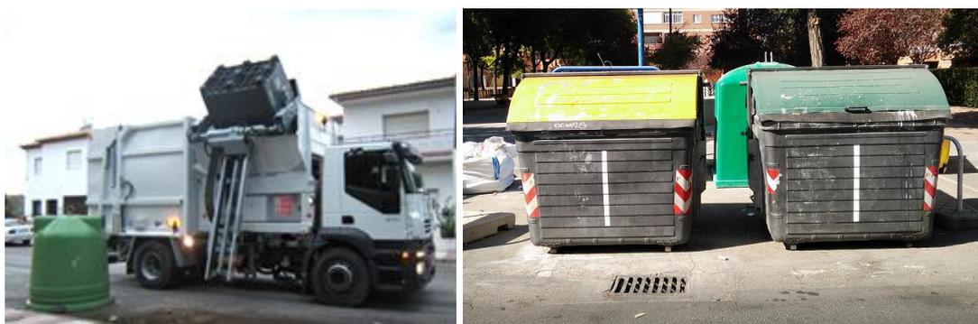
Ilustración 5. Recogida lateral de residuos domiciliarios. Izda. Camión recolector (Fuente: leganes.org). Dcha. Contenedores para envases ligeros y restos.
